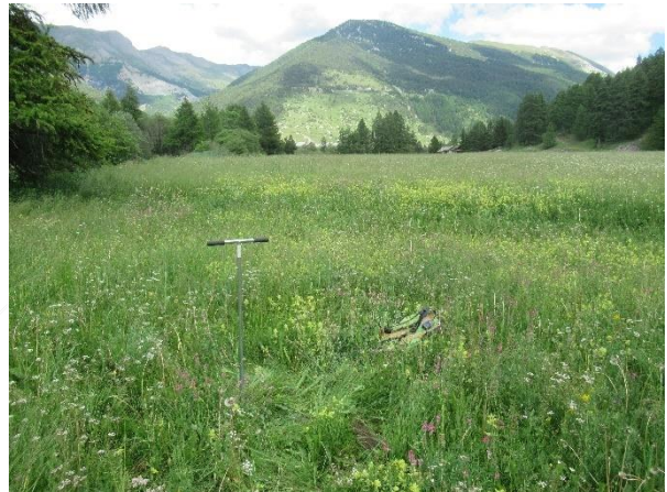
Profil 8 : Aucune trace d'hydromorphie, blocage à 30 cm.
