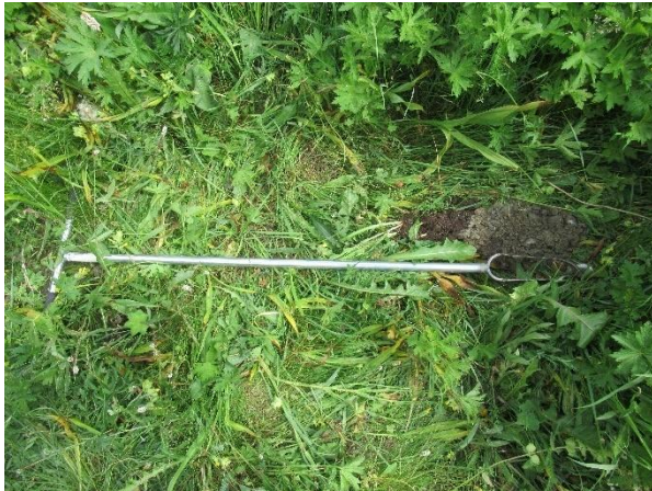
Profil 7 : Aucune trace d'hydromorphie, blocage à 40 cm.
