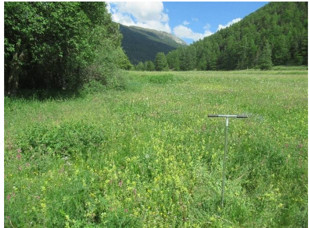
Profil 5 : Aucune trace d'hydromorphie, blocage à 20 cm.
