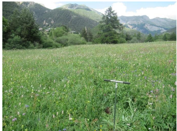
Profil 6 : Aucune trace d'hydromorphie, blocage à 30 cm.
