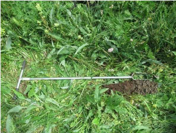
Profil 4 : Faibles traces rédoxiques à 30 cm, de plus en plus de cailloux, blocage à 50cm.
