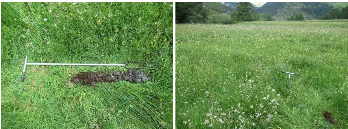
Profil 3 : Traces rédoxiques de 40 à 50 cm, gley au-delà, poursuite du profil au-delà de 80 cm.
