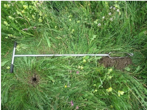
Profil 8 : Aucune trace d'hydromorphie, blocage à 30 cm.
