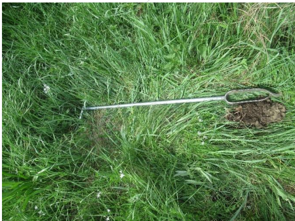
Profil 9 : Aucune trace d'hydromorphie, blocage à 20 cm.
