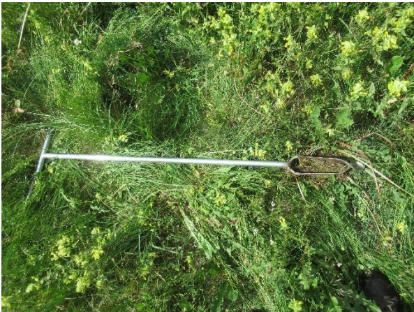
Profil 5 : Aucune trace d'hydromorphie, blocage à 20 cm.
