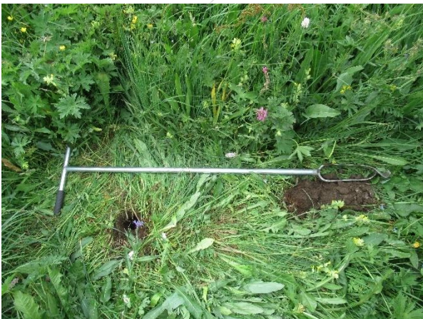
Profil 6 : Aucune trace d'hydromorphie, blocage à 30 cm.
