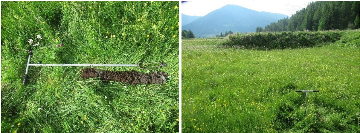
Profil 2 : Horizon histique mésique de 20 à 30 cm, traces rédoxiques de 30 à 40 cm, gley au-delà, nappe à 70 cm, poursuite du profil au-delà de 80 cm.
