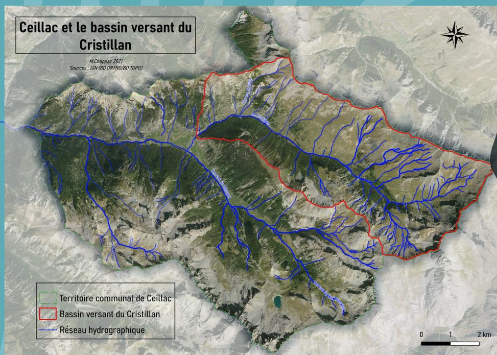
On appelle bassin-versant la surface pour laquelle tous les écoulements convergent vers un même point. En définissant cet exutoire à l'amont du village, le bassin versant du Cristillan couvre une superficie de 32 Km<sup>2</sup>.
